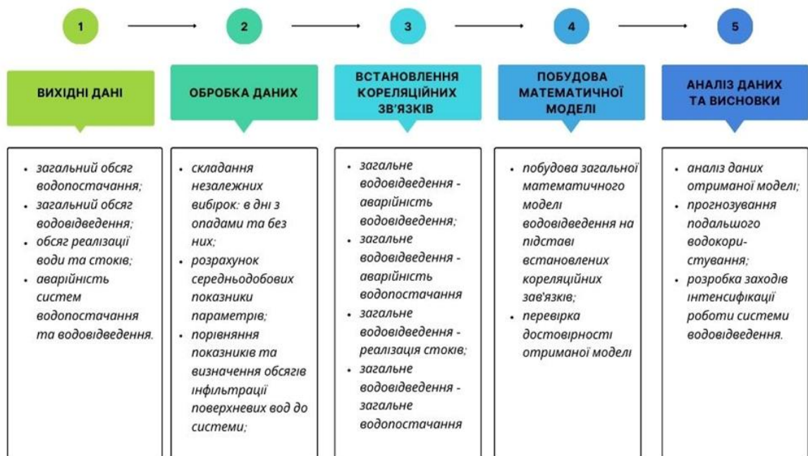
Рис. 1. Процес визначення інфільтрації та ексфільтрації балансово-аналітичним методом.
