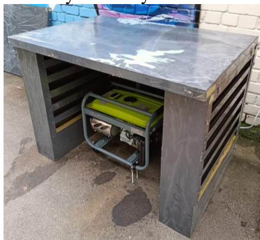
Рис. 2 Реалізований шумозахисний короб
