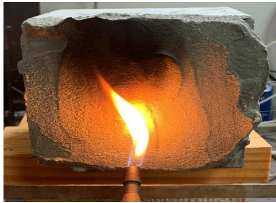
Рис. 2. Визначення ефективності вогнезахисту бетону
