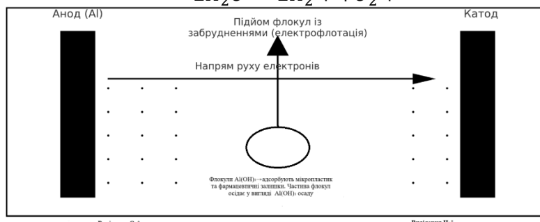
Рис.1 – Схема процесу електрокоагуляції-електрофлотації для видалення мікропластику та фармацевтичних забруднень
